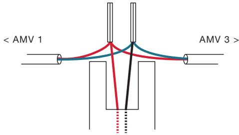
👉 Lorsque vous effectuez les raccordements entre deux Assécheurs, assurez vous de laisser une longueur de câble suffisante pour raccorder les appareils et les encastrer dans le mur.
