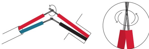
Torsader le fil rouge de l'Assécheur avec le fil rouge du câble, mettre en place le connecteur. Torsader le fil Noir de l'Assécheur avec le fil bleu (ou noir) du câble, mettre en place le connecteur.
