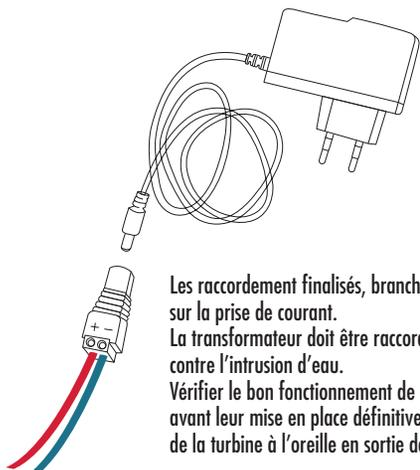
Les raccordements finalisés, brancher le transformateur sur la prise de courant.
