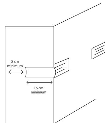
Ne pas traverser totalement le mur Laisser à minima 5 cm d'épaisseur de paroi.
