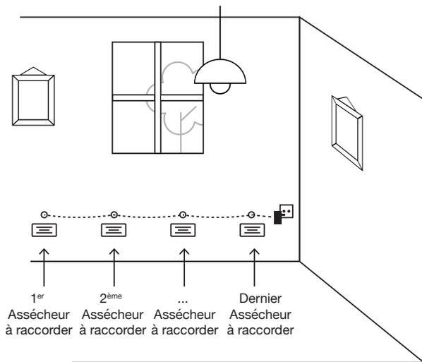
Le câble est fourni en bobine, pour le raccordement, il est nécessaire de dénuder chaque fil (rouge et bleu (ou noir selon le cas)) sur 1 cm à 1,5 cm. Le câble devra être coupé à la bonne longueur pour raccorder les Assécheurs entre eux. Le fil bleu (ou noir selon le kit de raccordement) du câble doit être raccordé au fil noir (borne -) de l'Assécheur et le fil rouge doit être raccordé au fil rouge (borne +) de l'Assécheur.
