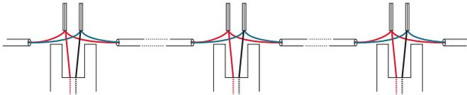
L'alimentation (transformateur) permet de raccorder jusqu'à 8 Assécheurs. Au-delà, il est nécessaire de monter un second «réseau» avec une seconde alimentation.
